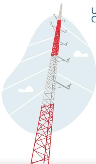
Un mât de mesure a été installé fin juillet sur la commune de Saint-Clément. Le mât, d'une hauteur de 124,5 m (paratonnerre compris), permet d'évaluer la vitesse et la direction du vent à différentes hauteurs pour estimer le potentiel du projet et la production des futures éoliennes.
